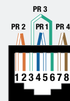
EIA/TIA568B AT&T 258A WIRING
